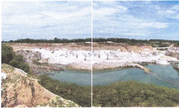
รูปที่ 1 พัฒนาหน้าเหมืองเป็นแบบขั้นบันได
